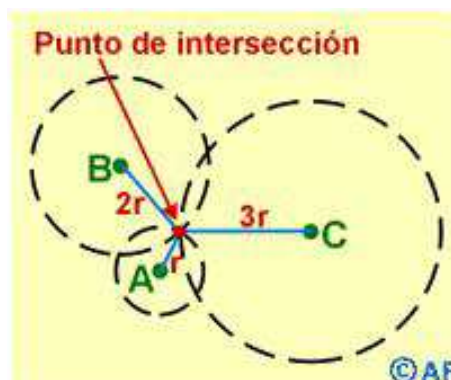
Figura 1.11: Principio básico de la triangulación.
