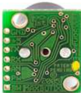
Figura 2.15: Pines de conexión LV-MaxSonar.
