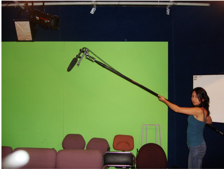
Figura 5. 10 Ubicación del micrófono boom en el set de grabación
