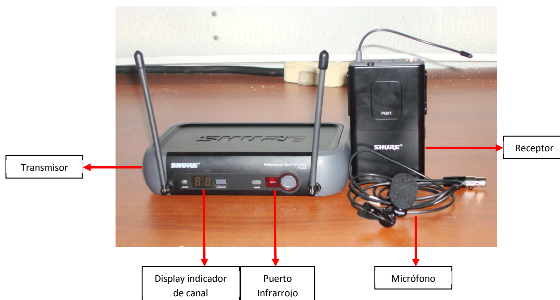
Figura 5. 12 Elementos un micrófono inalámbrico corbatero
