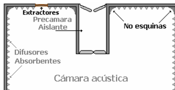
Figura 1. 12 Aislamiento acústico de una sala
