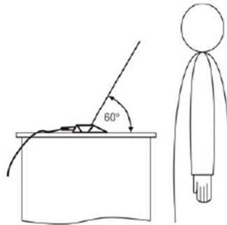
Figura 4. 8 Ubicación de un micrófono de contacto
