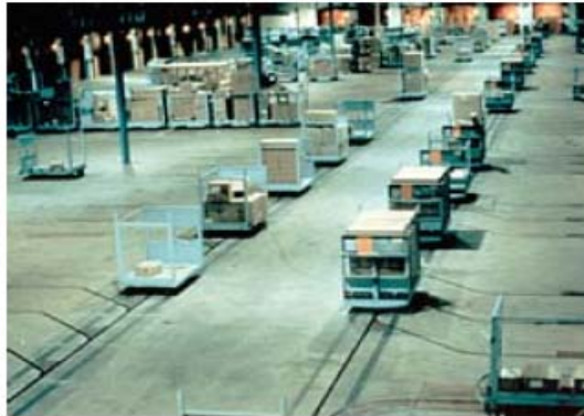
Figura 2.5. Sistema con cable enterrado
