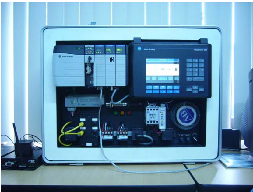
Figura 6.1. Maleta de pruebas Allen Bradley
