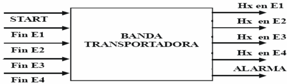
Figura 3.1. Banda Transportadora como bloque 6
