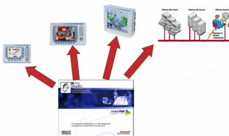
Figura 5.2 RSView utilizado desde un panel básico hasta sistemas integrados con sistema operativo
