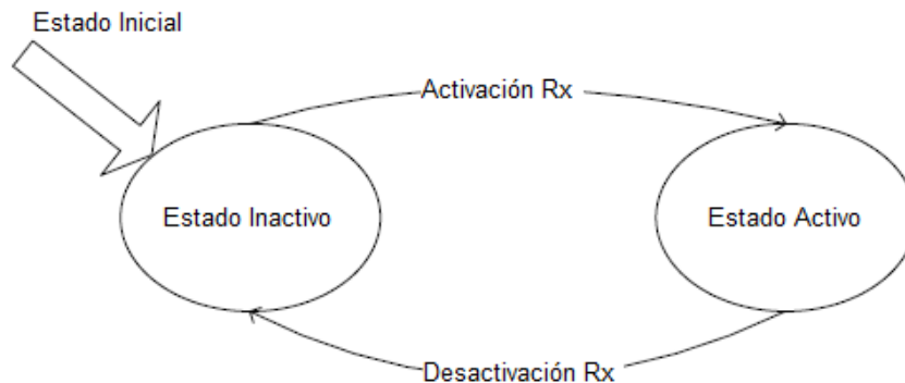
Figura 2.14: Diagrama de estados del protocolo Inter RAT
