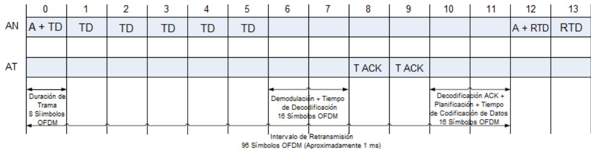
Figura 2.52: Tiempos de Retransmisión H-ARQ Extendida para el Enlace de Bajada
