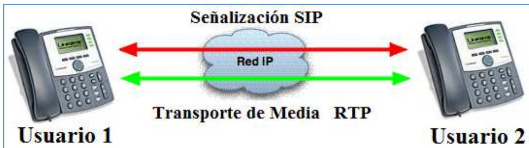
Figura. 3.2. Esquema de funcionamiento del protocolo SIP, orientado a conexiones *peer to peer*.
