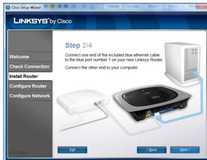
**Figura. 4.12. Instalación del router Linksys: Paso 5.**
