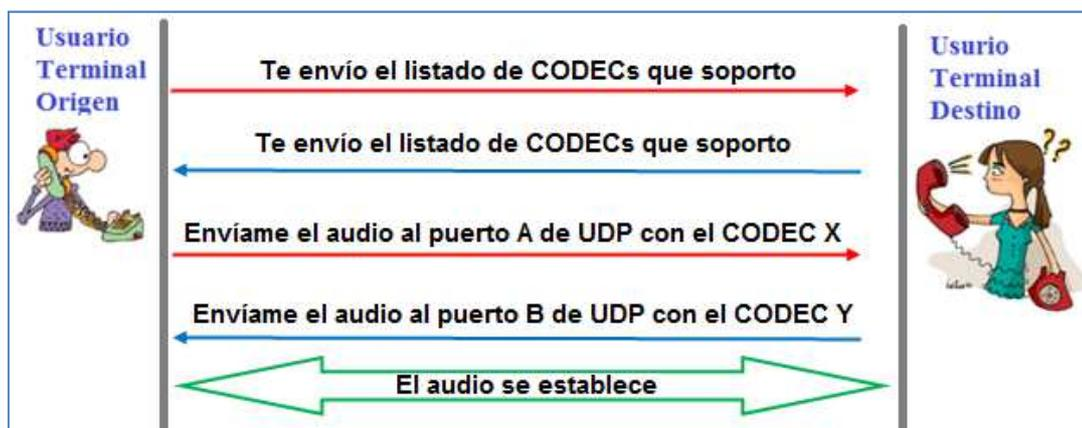
Figura. 2.27. Ejemplo explícito de mensajes de los protocolos de control de señalización de llamada.
