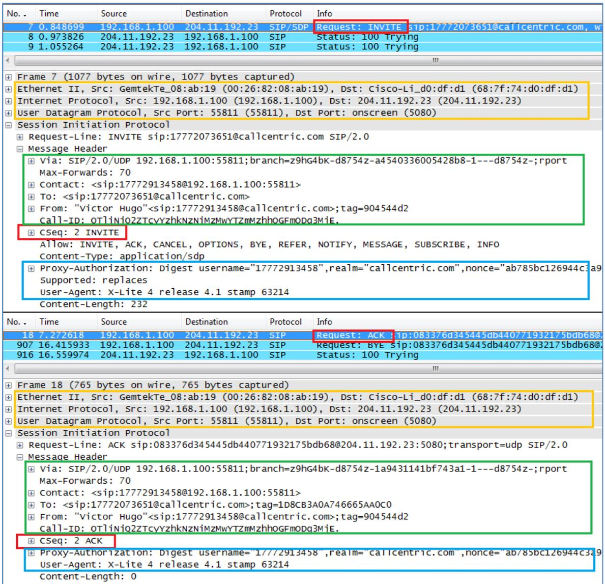
Figura. 5.11. Comparación entre los mensajes INVITE y ACK.
