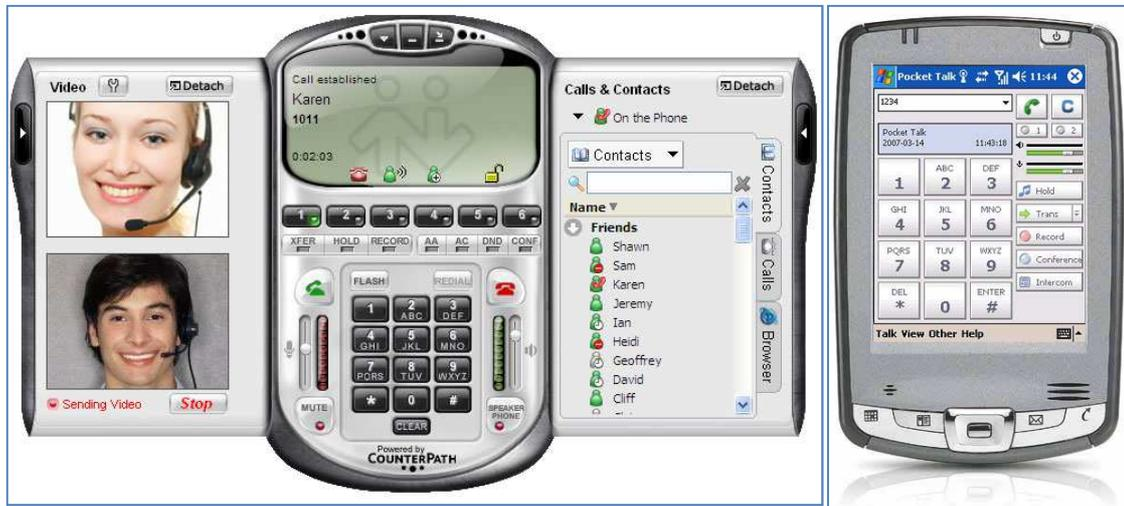
Figura. 3.9. Softphone X-Lite para PC y teléfono celular con aplicación SIP.
