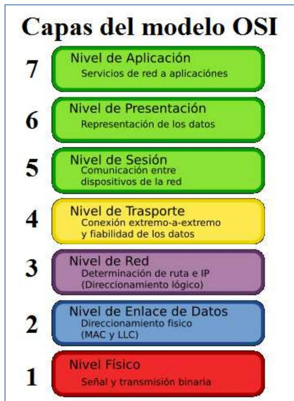
Figura. 2.5. Capas del modelo de referencia OSI.
