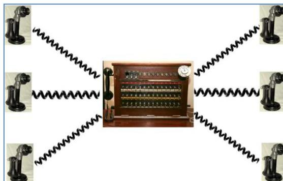
Figura. 1.4. Conexión de teléfonos a la centralita.
