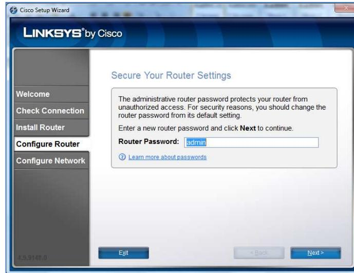
Figura. 4.15. Configuración del router Linksys: Paso 8.
