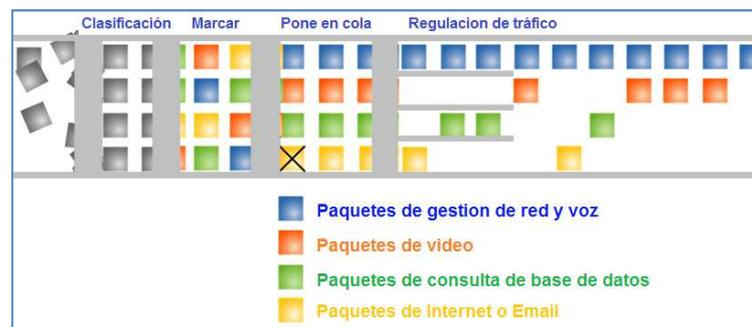
Figura. 2.35. Procedimiento para ofrecer QoS en un dispositivo de red.
