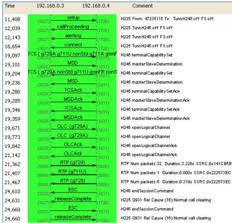
Figura. 2.29. Intercambio de mensajes del protocolo de control de señalización de llamada H.245.
