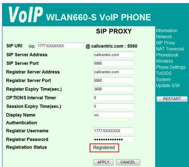
**Figura. 7. Pantalla configuración web: configuración SIP.**
