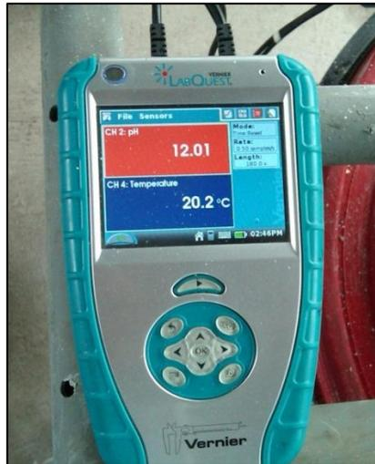
Figura 2.5. Dispositivo LabQuest de Vernier, para la medición de pH y Temperatura (López, 2011).
