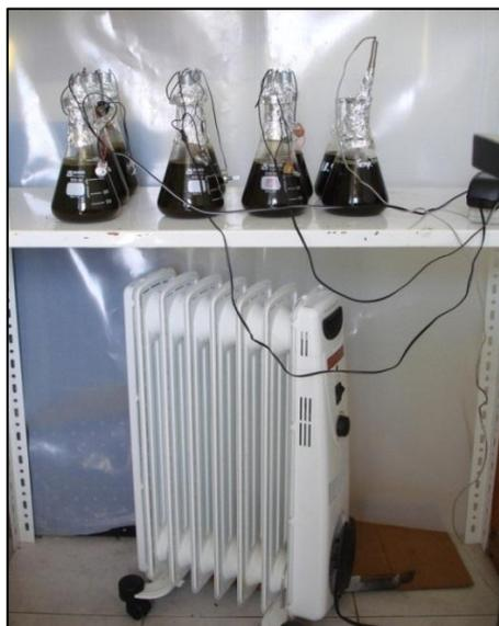
Figura 2.4. Adaptaciones realizadas para los ensayos preliminares, para suplantar el uso de una incubadora con agitación (López, 2011).
