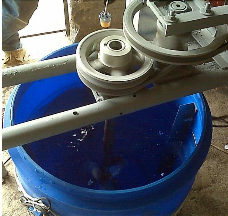
Figura 2.11. Prueba de funcionamiento de la hélice y verificación de flujo y de fugas (López, 2011).
