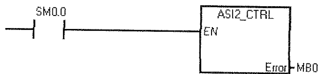
FIGURA 2.5.- Programa en STEP 7 para red AS-i
