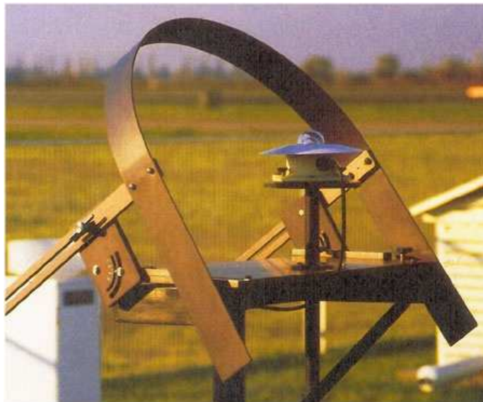
Figura 3.9 Piranómetro con banda de sombra para la medición de radiación difusa
