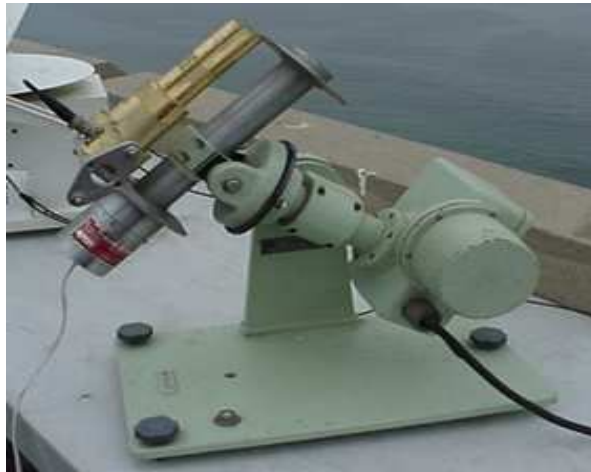
Figura 3.5 Pirheliómetro Secundario sobre un seguidor de sol
