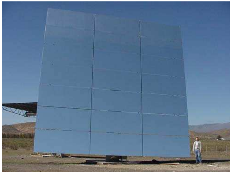
Figura 4.15 Heliostato de vidrio-metal de 90 m 2 de superficie reflexiva
