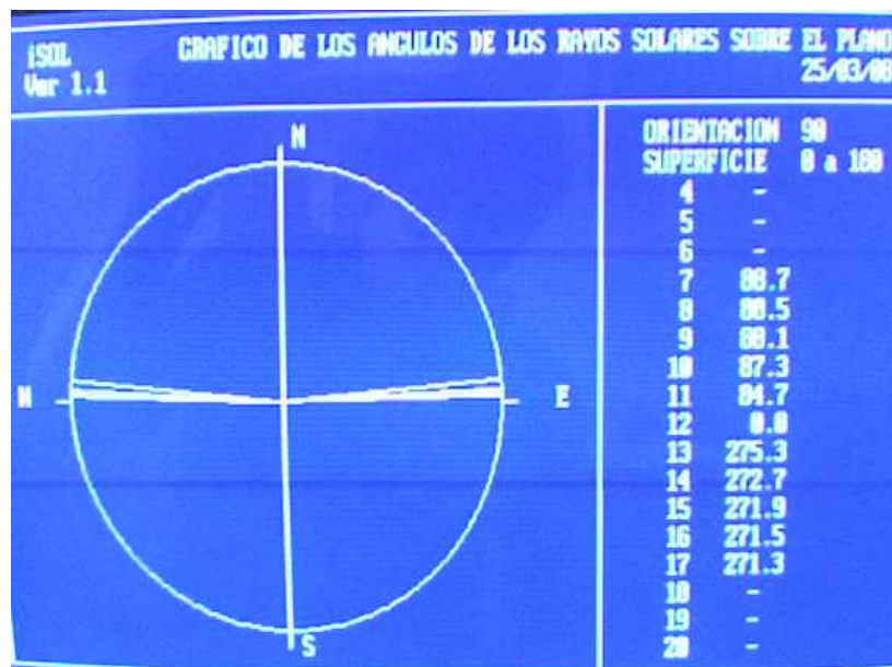
Figura 3.16 Gráfico de los ángulos de los rayos solares sobre el plano
