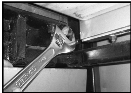
FOTOGRAFÍA 20: Calibrando posición del yunque. Ajuste o desajuste de pernos M12.
