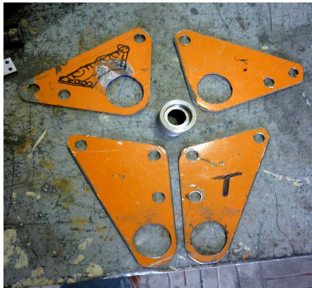
Figura 3.6. Platinas para las paredes de las bieletas
