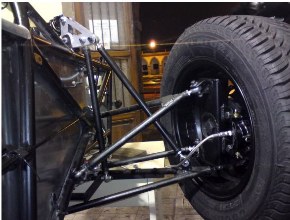
Figura 3.14. Vistas de la suspensión delantera
