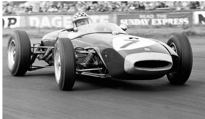
Figura 1.17. Lotus Climax 1960 nótese el conjunto resorte-amortiguador
