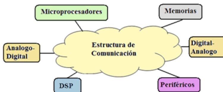
**Figura. 2.10. Estructura de la Comunicación en un System on Chip**
