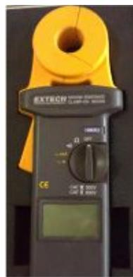
**Figura 3.1: Probador de Pinza para Resistencia de Tierra, modelo 382356**
