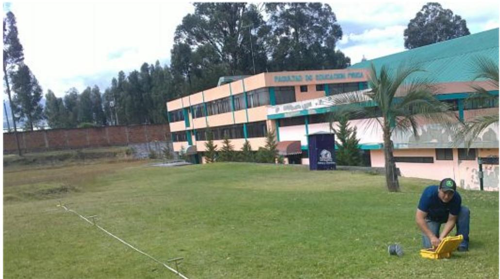
**Figura 3.6: Medición 1 - Medidor Digital de Resistencia de Puesta a Tierra modelo 4630**
