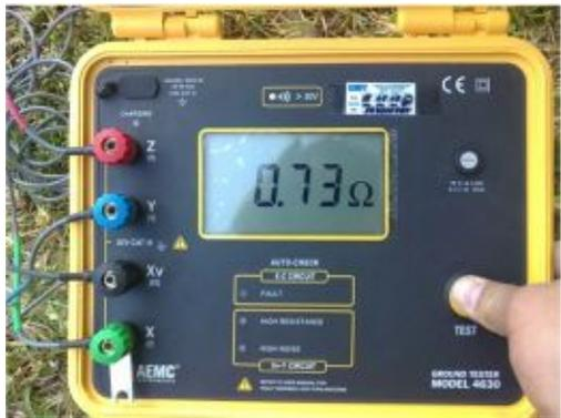
**Figura 3.7: Medición 2 - Medidor Digital de Resistencia de Puesta a Tierra modelo 4630**
