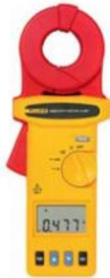
**Figura 2.20: Medidor de tierra tipo gancho**
