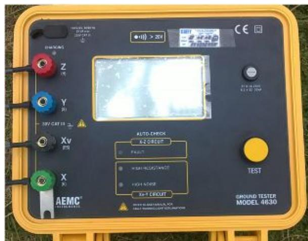
**Figura 3.4: Medidor Digital de Resistencia de Puesta a Tierra modelo 4630**
