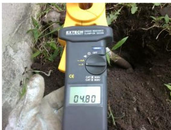
**Figura 3.3: Medición - Probador de Pinza para Resistencia de Tierra, modelo 382356**
