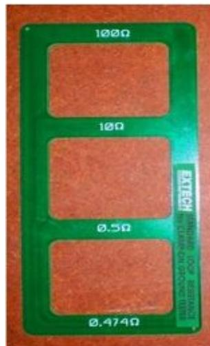
**Figura 3.2: Placa de prueba de resistencia, EXTECH Instruments.**
