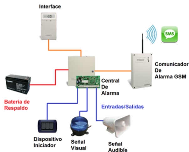
Figura 2.5. Ejemplo de un Sistema de Alarma
