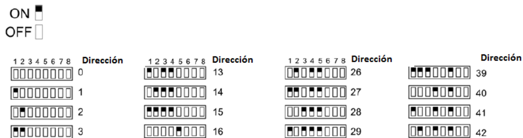
Figura 3.5. Direccionamiento de dispositivos SLC Hochiki mediante DIP Switches
