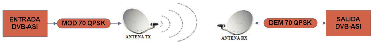
Figura. 5. 3. Diagrama de red de la infraestructura externa referente a la frecuencia auxiliar para los dos enlaces en Quito
