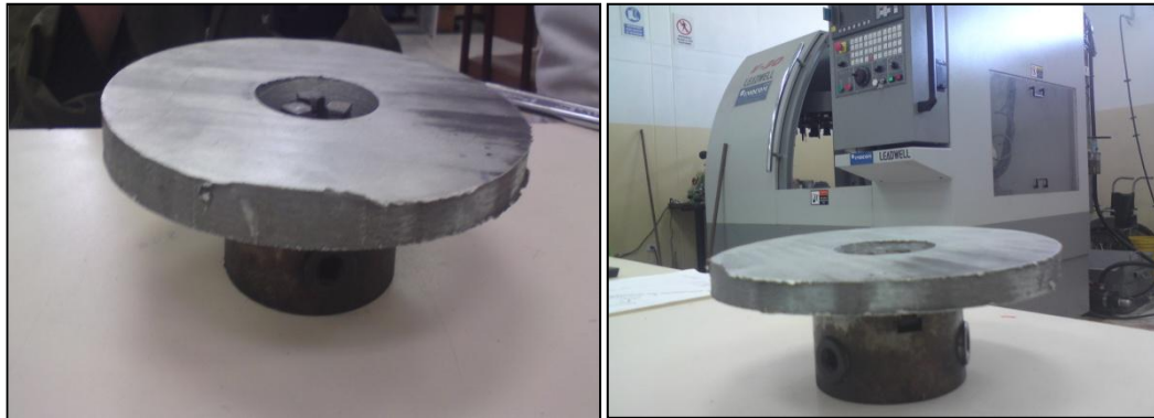
Fig. 3.19 Sujeción para hacer la manzana de la catalina en la CNC
