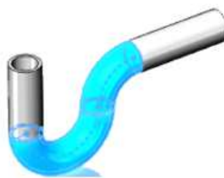
Figura 5.3 Base de cañería de desagüe
