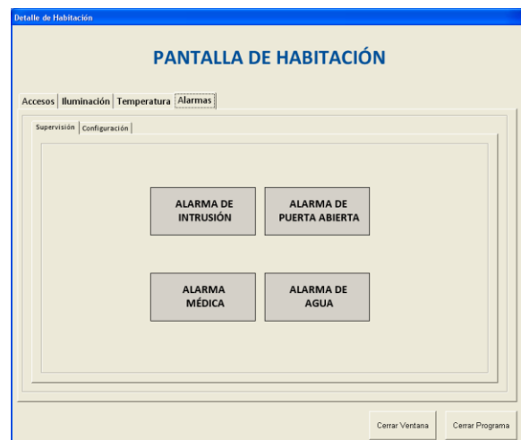
Figura 23. Pestaña de Supervisión de Alarmas.
