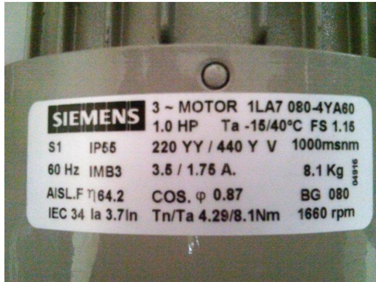
Figura 3. 6 Datos de la Placa del motor
