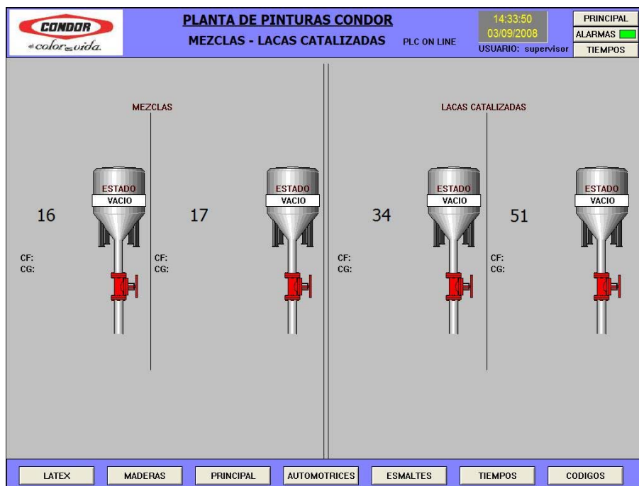
Figura 5.10. Ventana de la Línea de Lacas Catalizadas y Mezclas
