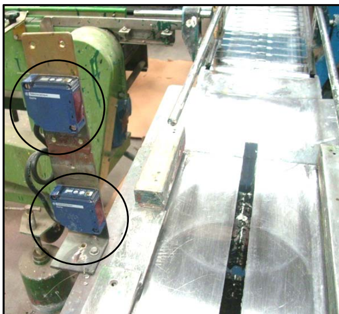
Figura. 6.22. Sensores instalados en la envasadora DEVREE
