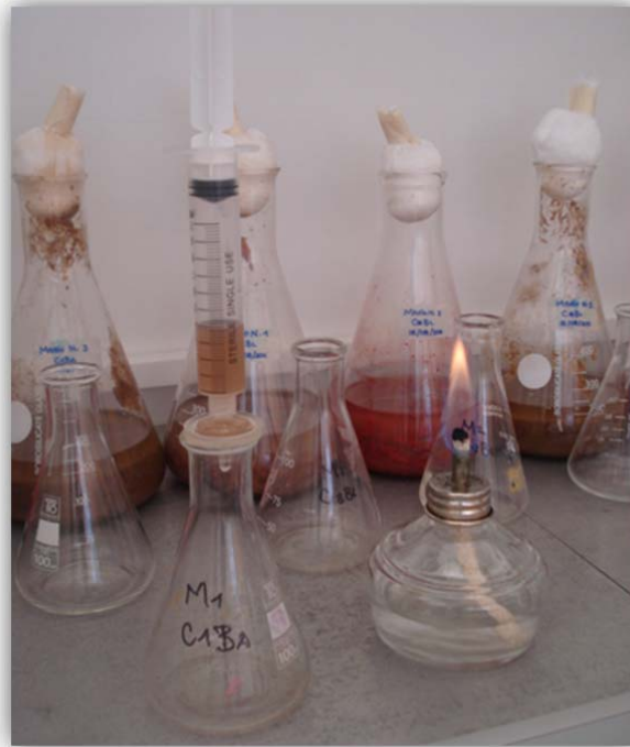
Figura 2.5 Filtración de medios naturales para la producción de enzimas con filtros millipore para jeringa de 0,2 µm.
