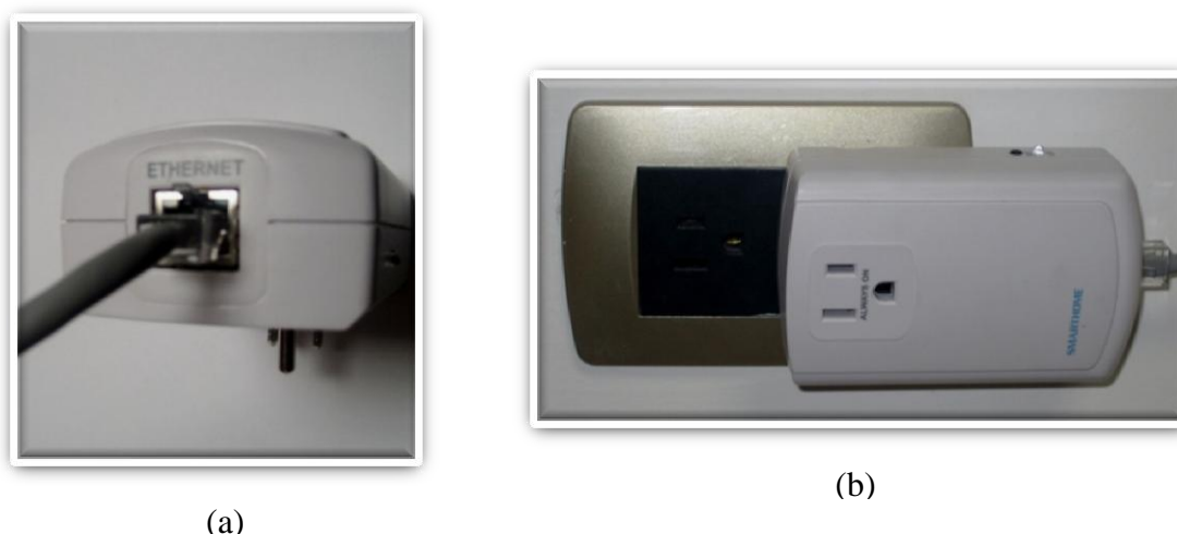
Figura. 5.7. Conexión Controlador Central SmartLinc
