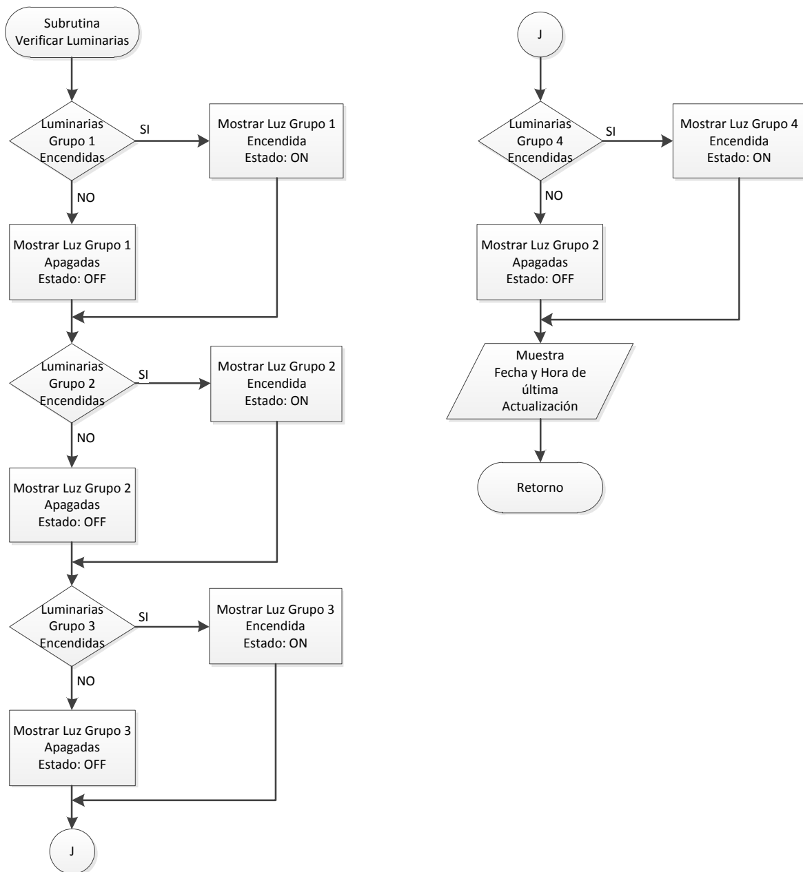
Figura. 6.20. Diagrama de Flujo - Subproceso Verificar Estado Luminarias
