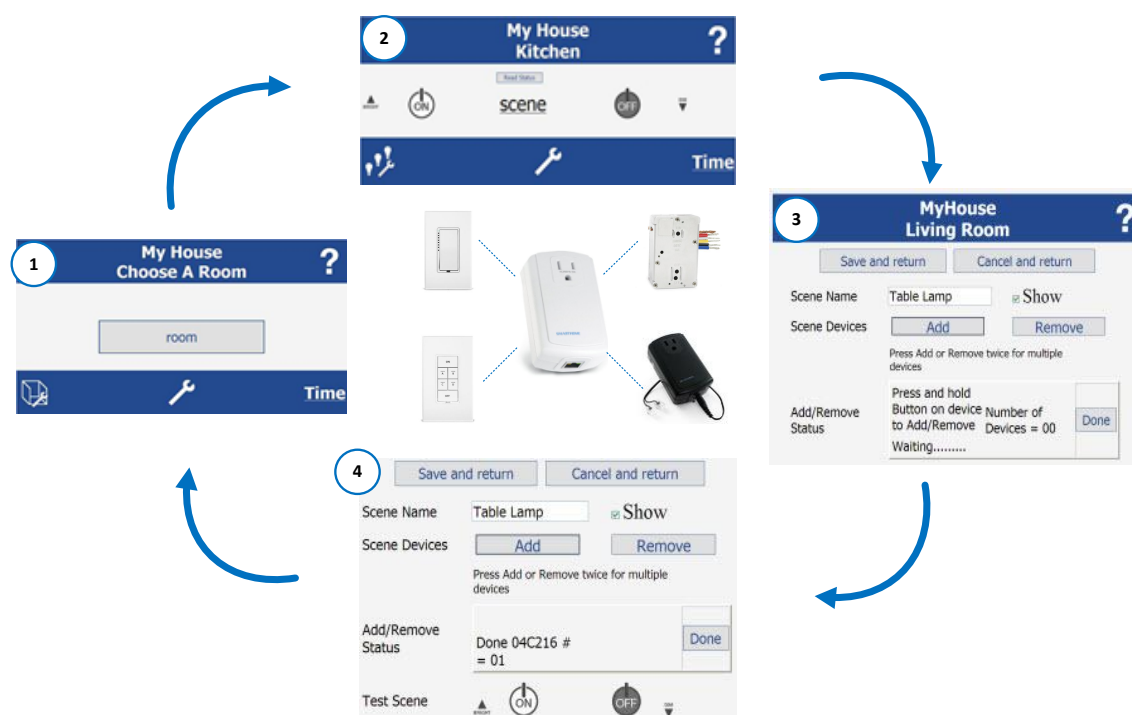
Figura. 5.24. Enlace Controlador SmartLinc con módulos INSTEON
