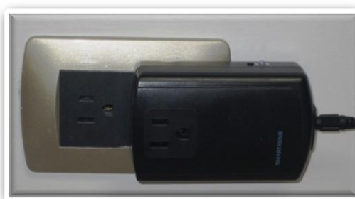
Figura. 5.5. Conexión IRLinc a Toma Corriente
