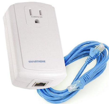
Figura. 4.5. Controlador Central SmartLinc 2412N
