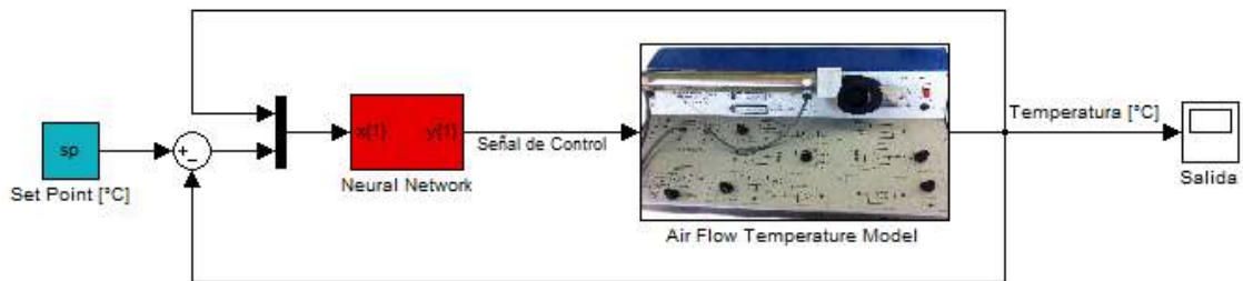
Figura 4.19 Diagrama de simulación del controlador neuronal inverso
