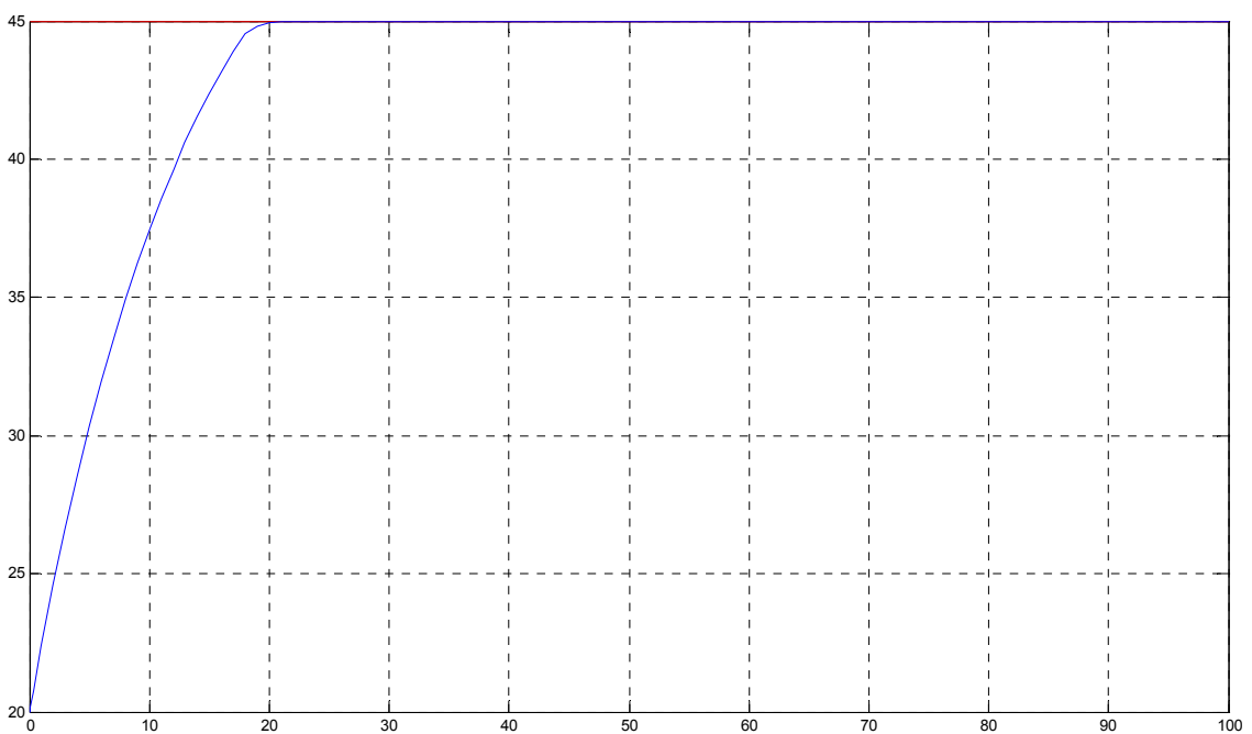
Figura 4.22 Respuesta en el tiempo de la simulación del controlador neuronal inverso con entrada de 45^{\circ}\text{C} .
