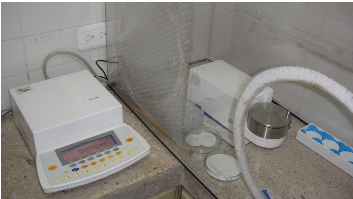
Figura 4.10. Balanza SE2-F en su cabina especial
