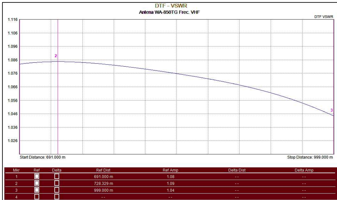
Figura 3. 41 Medición DTF-VSWR para VHF Antena WA-850TG
