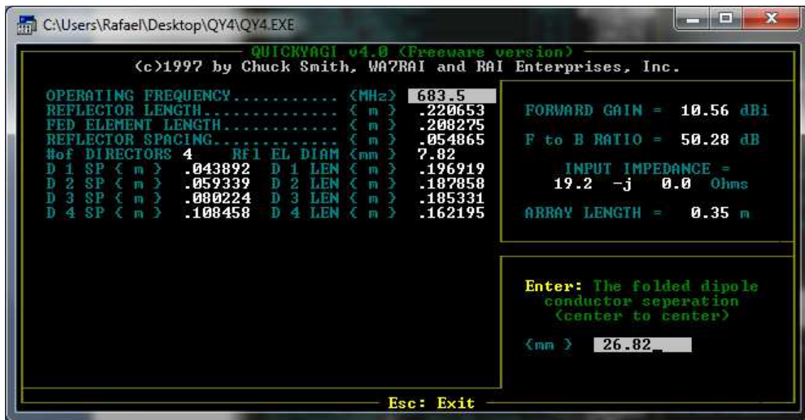
Figura 2. 25 Pantalla QY4 con la separación del dipolo doblado
