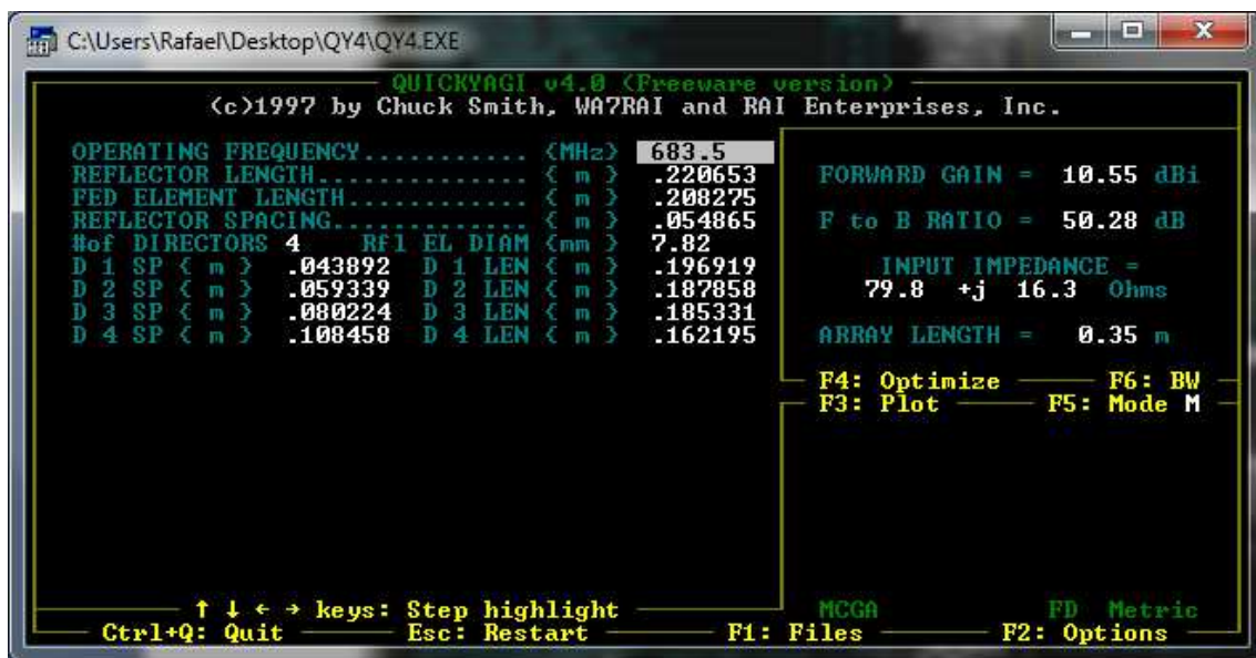
Figura 2. 26 Pantalla QY4 resultado de diseño al cambiar a dipolo doblado
