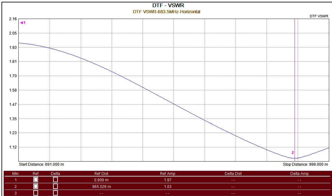
Figura 3. 5 Medición DTF-VSWR polarización horizontal antena 683.5MHz
