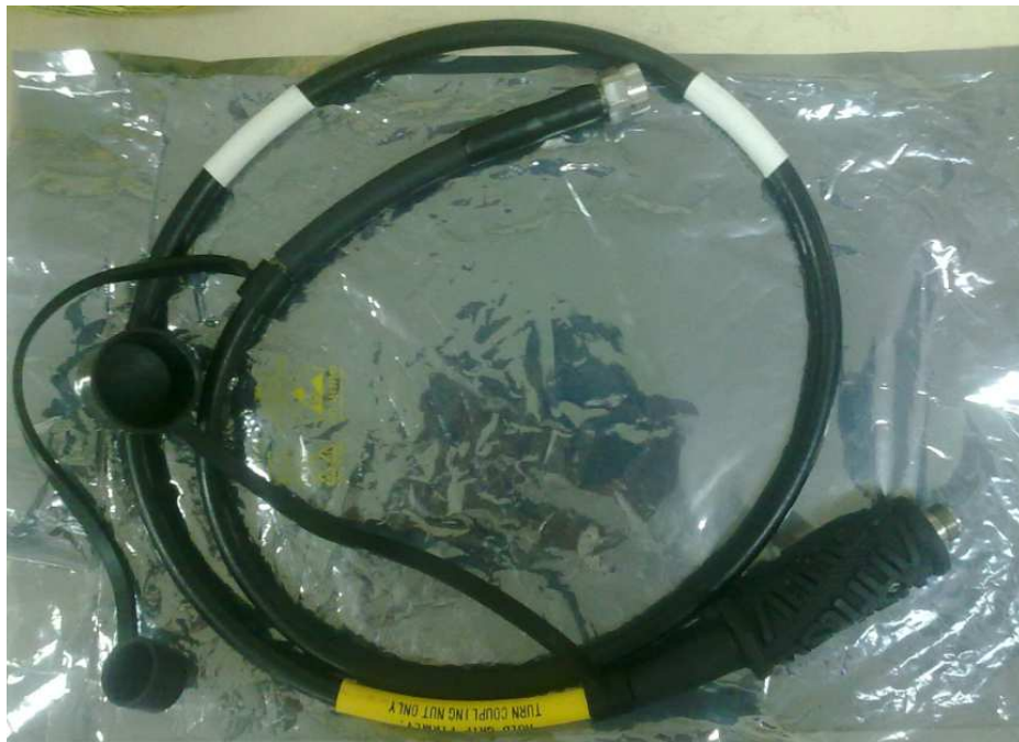
Figura 1. 9 Cable para puerto de Prueba reforzado con armadura de agarre
