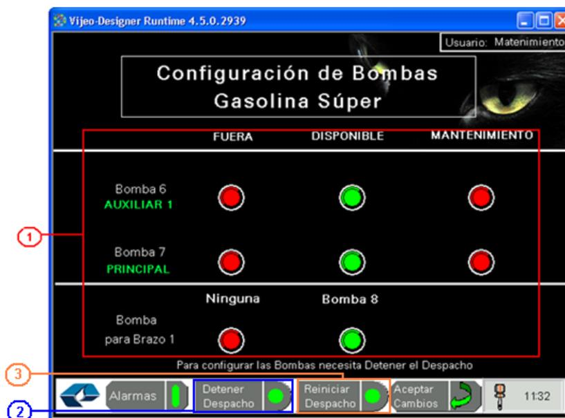
Figura 2.79. Imagen de la ventana configuración de bombas de gasolina súper de la HMI MAGELIS.
