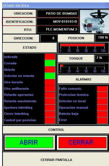
Figura 2.50. Imagen de la ventana estado de la válvula.
