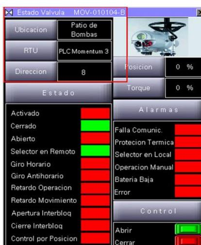
Figura 2.63. Imagen de la ventana estado válvula de gasolina extra con variador de la HMI MAGELIS.
