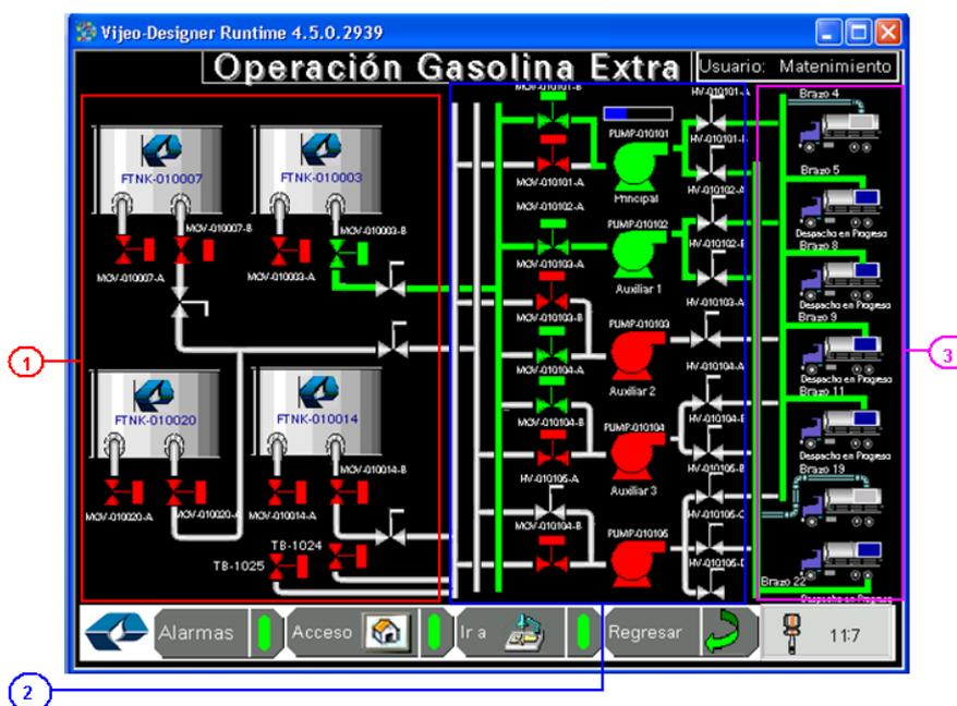
Figura 2.60. Imagen de la ventana operación gasolina extra del sistema de la HMI MAGELIS.
