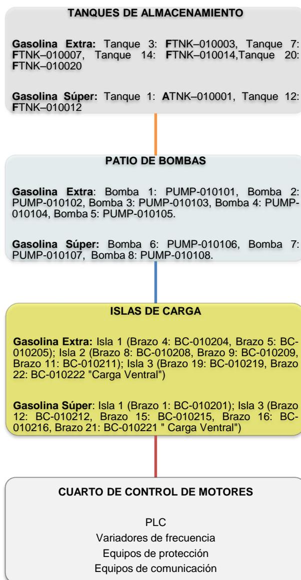
Figura 1.1. Diagrama de bloques general de la infraestructura física del sistema de despacho de gasolina Extra y gasolina Súper.
