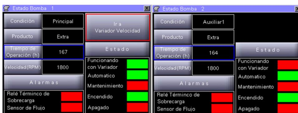
Figura 2.61. Imagen de la ventana estado bomba de gasolina extra con arranque directo de la HMI MAGELIS.
