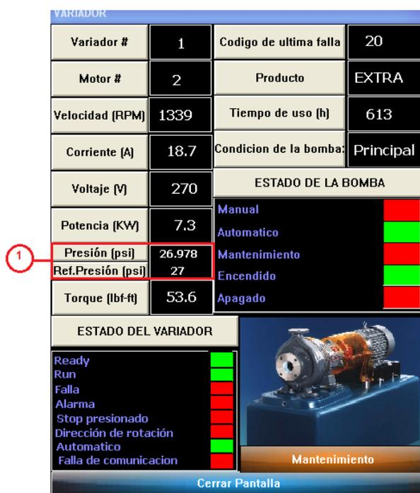
Figura 2.47. Imagen de la ventana donde se muestra la información del Variador de Frecuencia.
