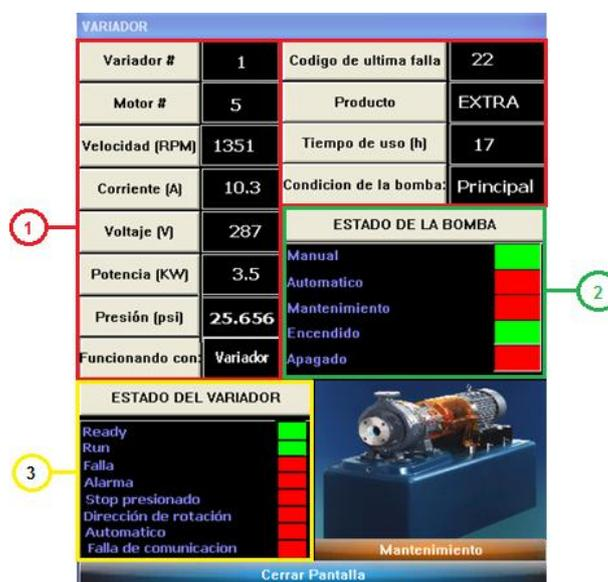
Figura 2.106. Pantalla estado bomba con variador de gasolina extra.
