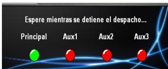
Figura 2.43. Imagen de la ventana emergente que indica el progreso al detener las electrobombas de gasolina extra.
