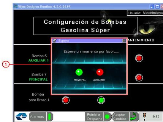
Figura 2.80. Imagen de la ventana espera para detener ó reiniciar despacho de gasolina súper de la HMI MAGELIS.
