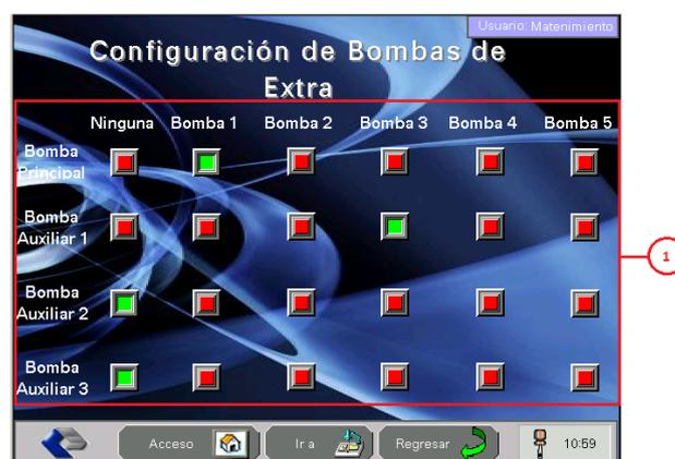
Figura 2.9. Pantalla antigua configuración bombas extra de la HMI MAGELIS<sup>2</sup>
