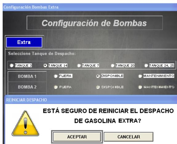
Figura 2.44. Imagen de la ventana emergente de confirmación que aparece cuando se presiona el botón Reiniciar despacho.
