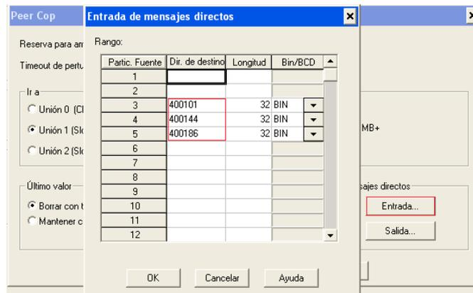
Figura 2.6. Mensajes directos de entrada (Unión 1 Slot 2) recibidos desde los PLC's Momentum del patio de bombas y tanques de almacenamiento.
