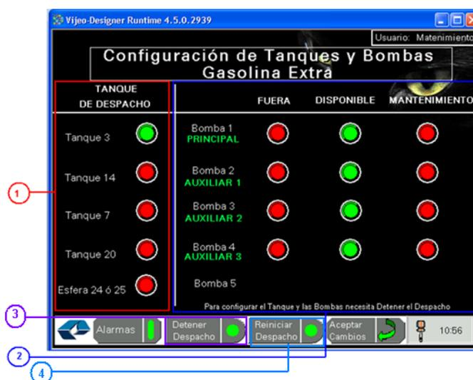
Figura 2.57. Imagen de la ventana configuración de tanque y bombas de gasolina Extra de la HMI MAGELIS.
