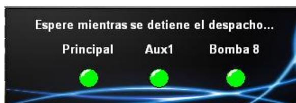
Figura 2.75. Imagen que muestra la ventana emergente que indica el progreso de la secuencia para detener las electrobombas.
