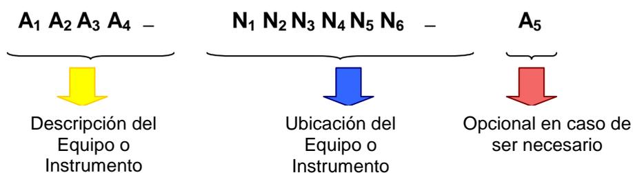
Figura 3.1. Codificación de equipos e instrumentos del terminal Beaterio<sup>6</sup>
