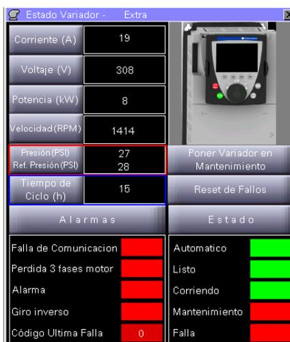
Figura 2.62. Imagen de la ventana estado bomba de gasolina extra con variador de la HMI MAGELIS.
