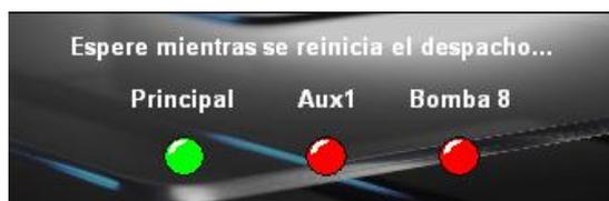
Figura 2.77. Imagen de la ventana de progreso de la secuencia de reinicio de la operación de las electrobombas.
