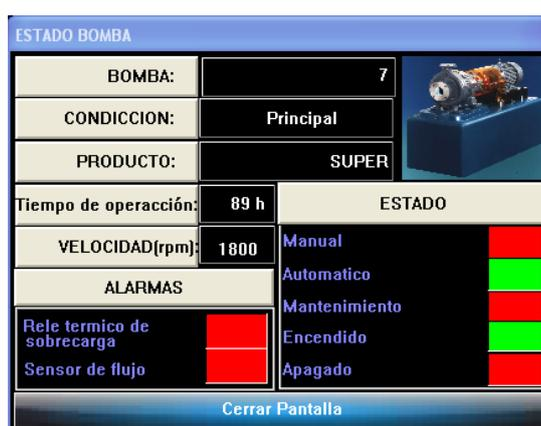
Figura 2.72. Imagen de la ventana de información de la electrobomba 7 de gasolina Súper.
