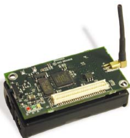
Figura. 2.2. Nodos o Motas Crossbow MPR2400
