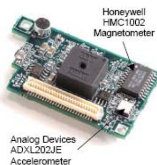
Figura. 3.3. Sensores MTS310 con acelerómetro y magnetómetro
