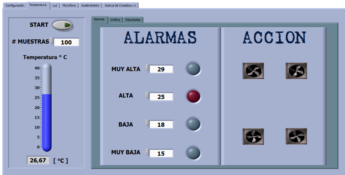
Figura. 4.5. Pantalla Temperatura – Alarma Alta
