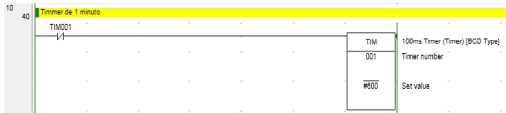
Figura. 4.12. Programación temporizador PLC
