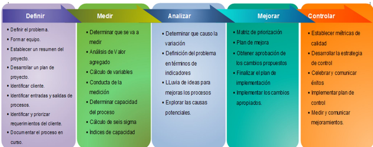
Figura. 2 Actividades utilizadas durante la aplicación del modelo DMAIC de Seis Sigma
