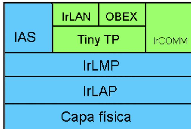
**Figura. 2.17.** Protocolo de comunicación IrDA
