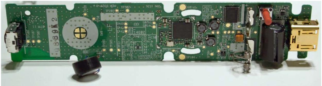
Figura. 2.22. Imagen inferior de la placa de circuito impreso del Wiimote
