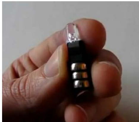
**Figura. 3.5.** Pieza con baterías, led y pulsador
