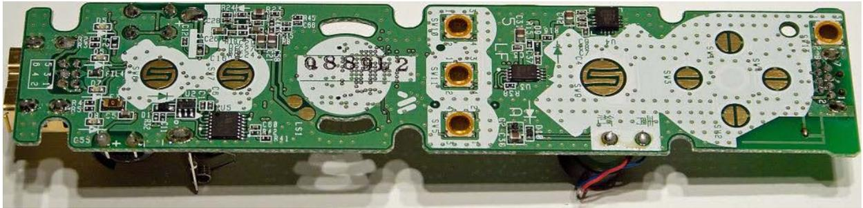
Figura. 2.21. Imagen superior de la placa de circuito impreso del Wiimote
