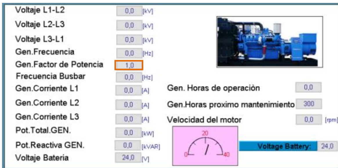
Figura. 4.7. Verificación del dato leído correspondiente al factor de potencia en el HMI
