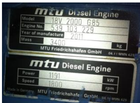
Figura. 2.4. Datos técnicos del motor MTU
