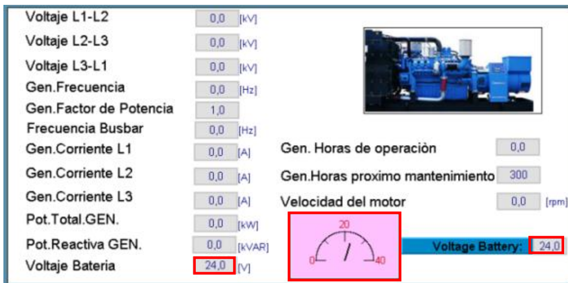
Figura. 4.3. Verificación del dato leído correspondiente a la fuente de alimentación en el HMI
