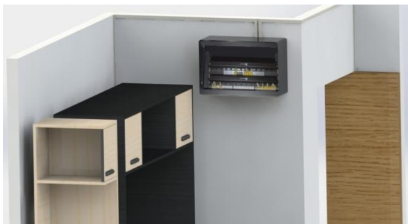
Figura. 3.66. Ubicación del rack, switch y patch panel
