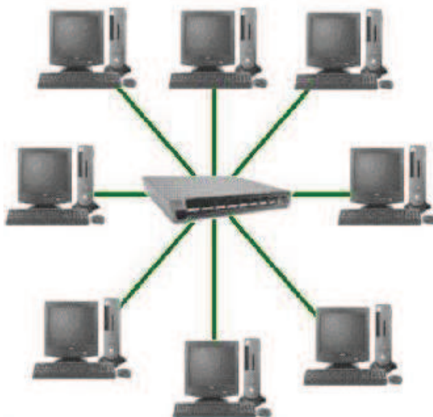
Figura. 1.12. Topología de Red tipo Estrella ( http://www.nicklabs.com.ar/?p=1687 )
