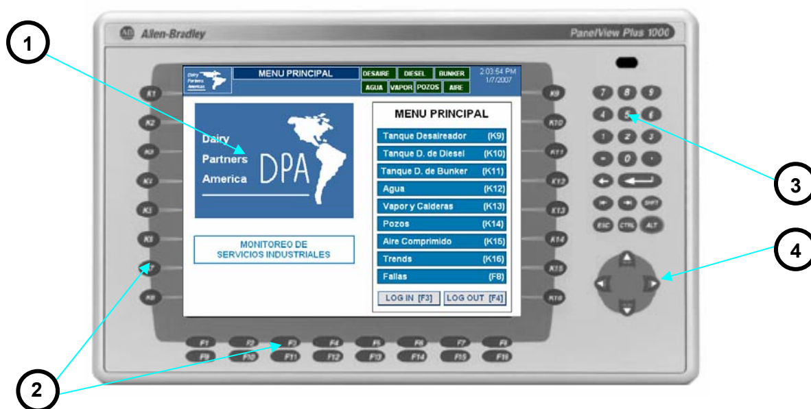
Figura. 2.6. Partes de un Panel de Operador
