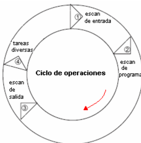
Figura. 2.4. Ciclo de Trabajo del PLC
