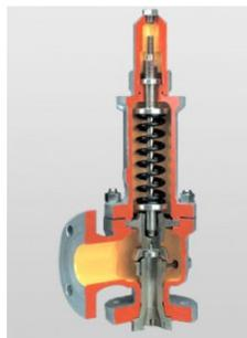
Figura. 3.12. Válvula de seguridad.
