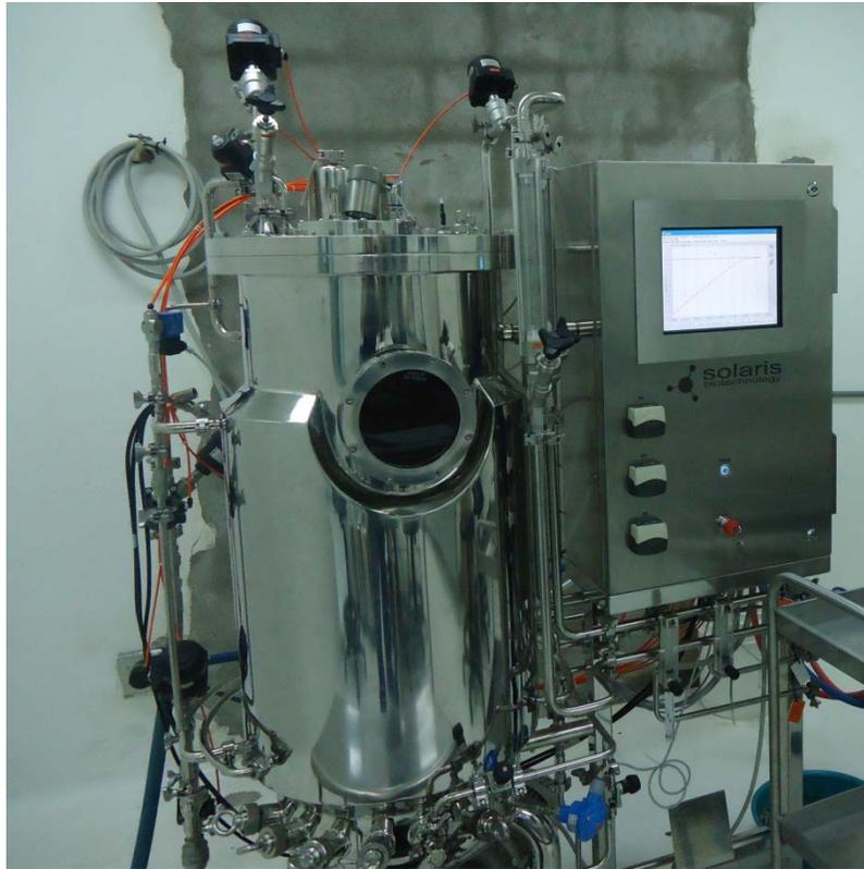
Figura. 5.7. Bio-Fermentador marca Solaris.
