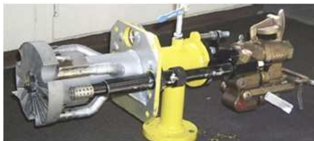
Figura 2.18: Quemadores de carbón pulverizado para bajos \text{NO}_x
