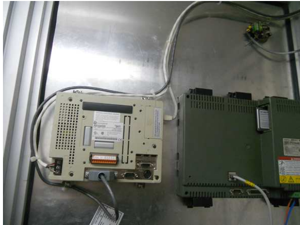
Figura 5.20. Conexión del PLC con la pantalla táctil Magelis para monitoreo.
