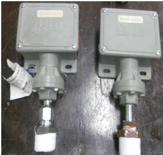
Figura 4.6. Interruptores de Presión líneas principales.
