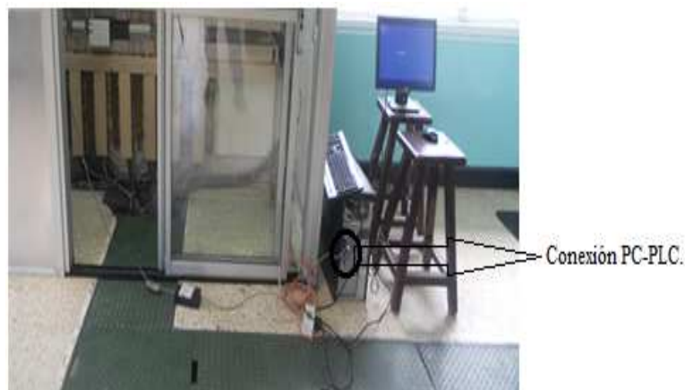
Figura 5.19. Conexión del PLC con la PC para su programación.
