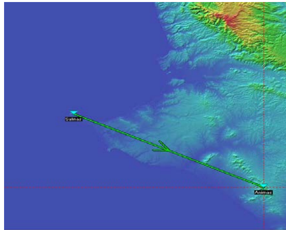
Figura 4.4. Enlace Salinas - Ánimas en Radio Mobile.
