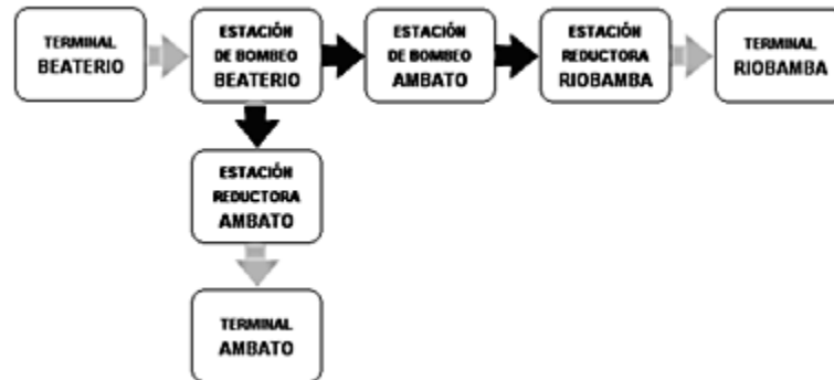
Figura 3. 38 Diagrama de Flujo Poliducto Quito Ambato Riobamba
