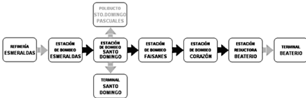
Figura 3. 36 Diagrama de Flujo Poliducto Esmeraldas Quito
