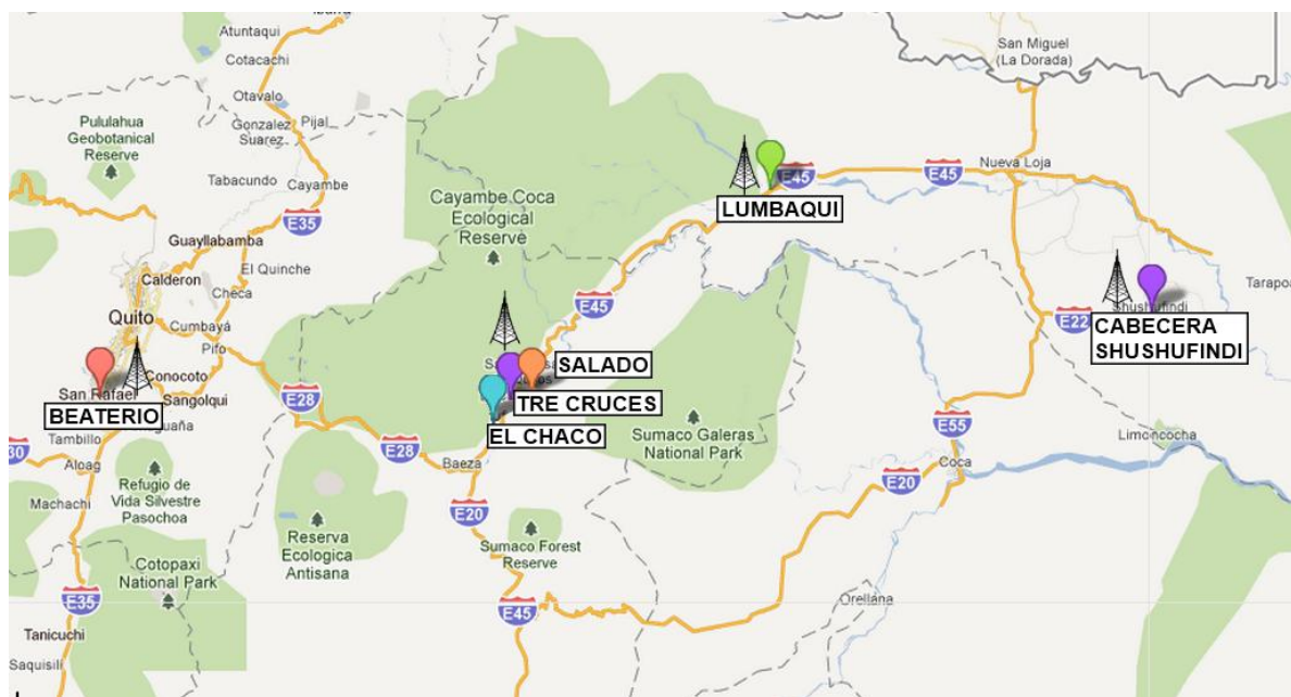
Figura 2. 3 Ubicación de antenas del sistema VHF del Poliducto Shushufindi – Quito
