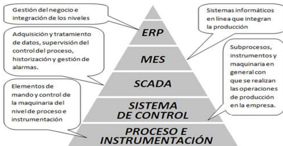
Figura 2. 1 Pirámide De Automatización 3
