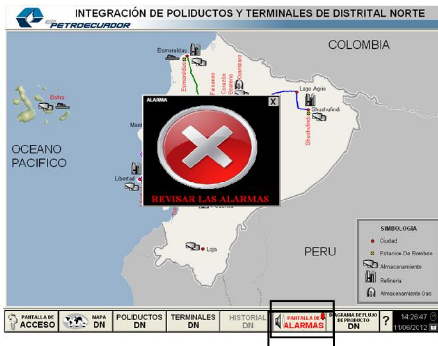
Figura 5. 16 Pantalla en caso de la existencia de una alarma
