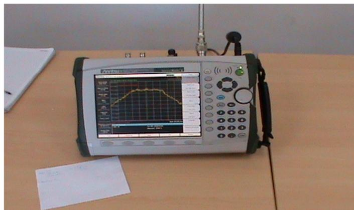
**Figura 3.2. Analizador de Espectro**
