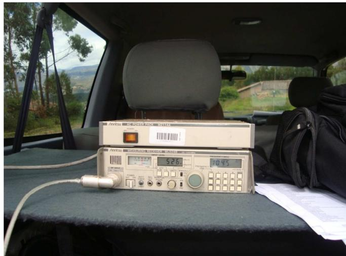
**Figura 3.3. Medidor de la intensidad de Campo**
