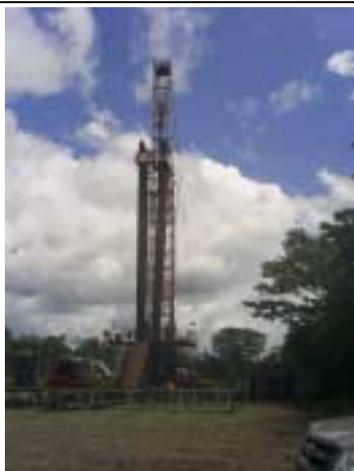
**Figura. 4.36.** Torre de reacondicionamiento
