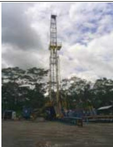
**Figura. 4.32.** Torre de reacondicionamiento
