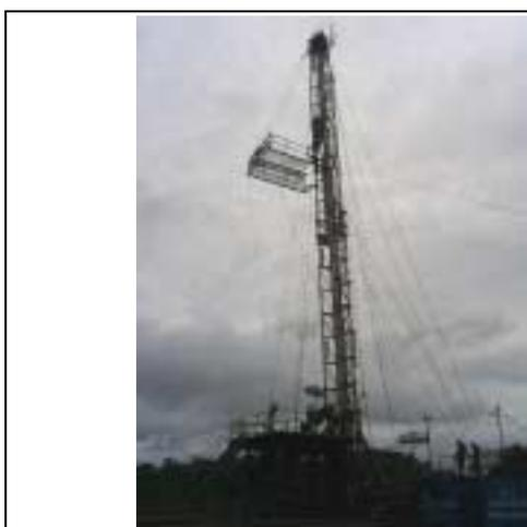
**Figura. 4.14.** Torre de reacondicionamiento
