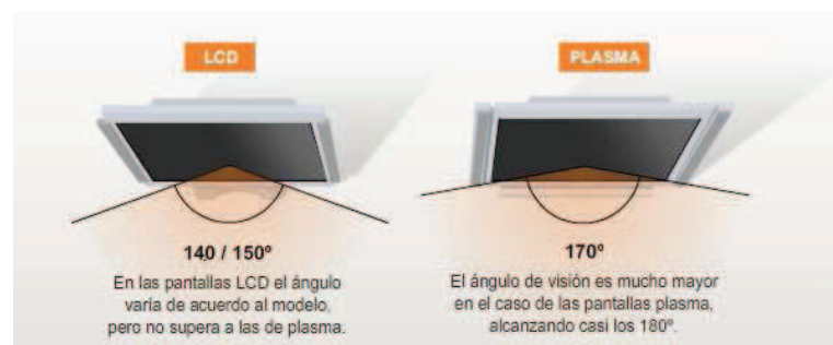
Figura. 2.6. Ángulo de visión en pantallas tipo LCD Y Plasma [6]
