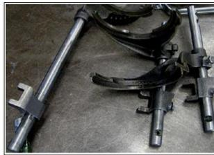
Figura. 1.17: Varilla selectora y horquilla.
