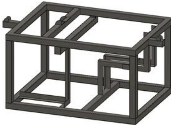
Figura 4.6. Estructura para caja de tracción delantera
