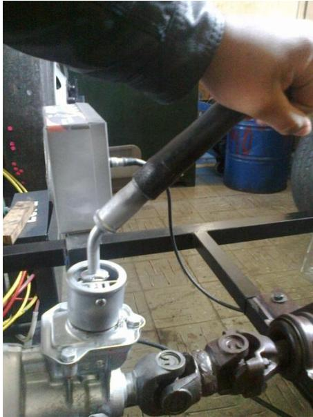
Figura A22. Palanca de cambios de la caja de tracción posterior.
