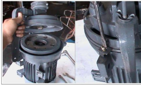
Figura 5.21: Unión con la base del embrague.
