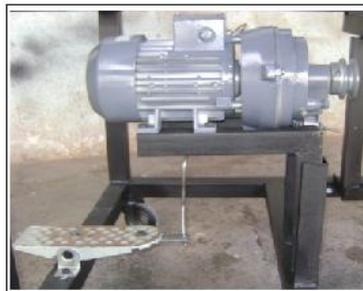
Figura 5.35: Embrague ensamblado en la estructura de la caja de velocidades de tracción delantera.
