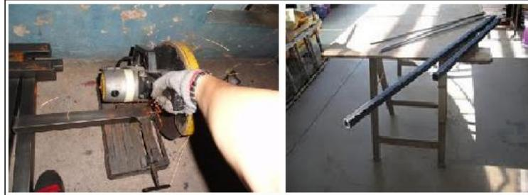
Figura 5.5: Corte del tubo estructural y del ángulo estructural.
