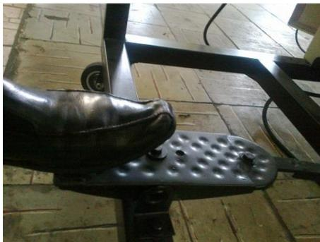
Figura A20. Accionamiento del pedal de embrague de la caja de tracción delantera.
