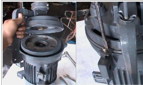
Figura 5.33: Unión con la base del embrague.
