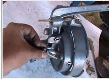
Figura 5.29: Colocación del conjunto de regulación de frenado.
