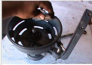
Figura 5.19: Colocación de la pastilla de freno.
