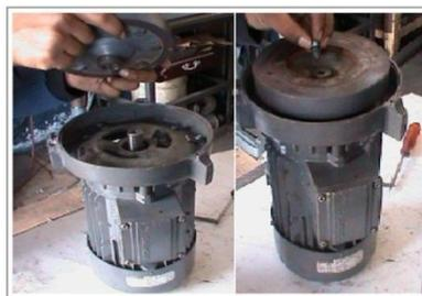
Figura 5.28: Sujeción del disco a la base.
