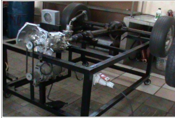
Figura 6.32: Simulador de la caja de velocidades mecánica de tracción posterior.
