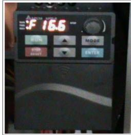
Figura 6.2: Variador de frecuencia a 1000 rpm o 16,66 Hz.
