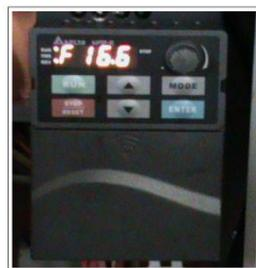
Figura 6.33: Variador de frecuencia a 1000 rpm o 16,66 Hz.
