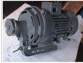
Figura 5.34: Mecanismo de embrague terminado.
