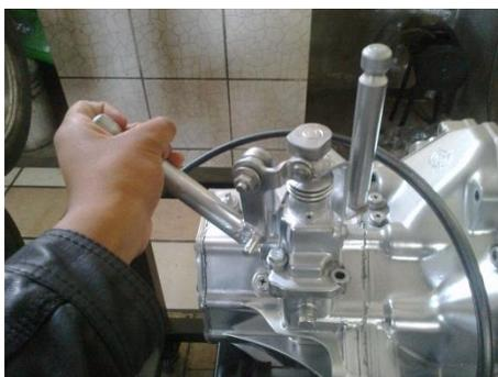
Figura A24. Palanca 1 de la caja de tracción delantera.
