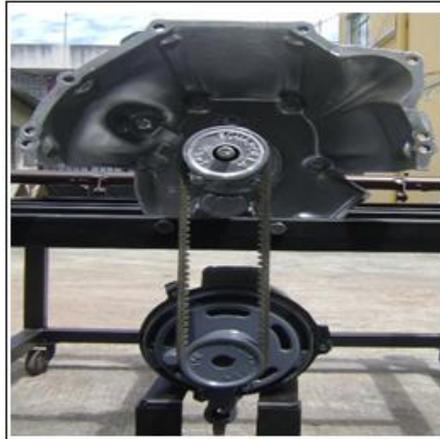
Figura 5.36: Mecanismo de transmisión de movimiento de la caja de velocidades tracción posterior.
