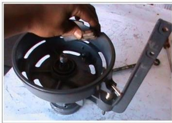
Figura 5.30: Colocación de la pastilla de freno.
