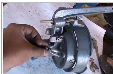
Figura 5.18: Colocación del conjunto de regulación de frenado.
