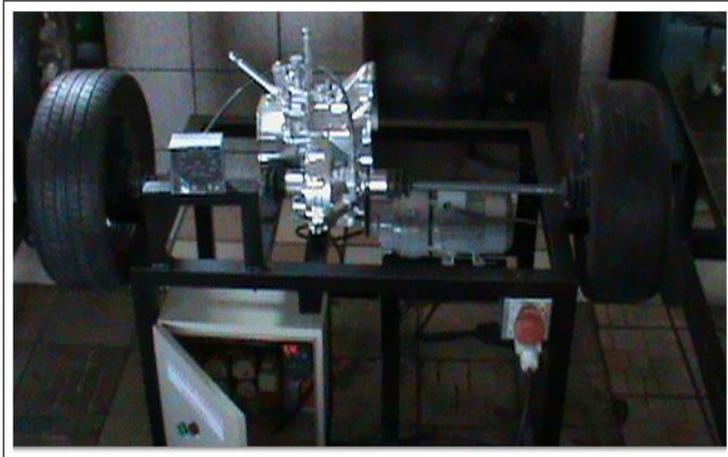
Figura 6.1: Simulador de la caja de velocidades mecánica de tracción delantera.
