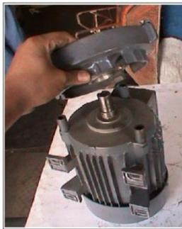
Figura 5.27: Colocación de la base del embrague.
