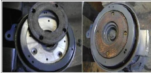
Figura 5.17: Sujeción del disco de embrague.
