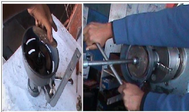
Figura 5.20: Colocación y ajuste del disco.
