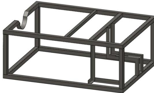
Figura. 4.1. Estructura para banco de tracción posterior
