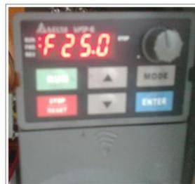
Figura 6.38: Variador de frecuencia a 1500 rpm o 25 Hz.
