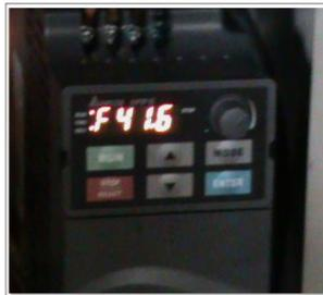
Figura 6.48: Variador de frecuencia a 2500 rpm o 41,66 Hz.
