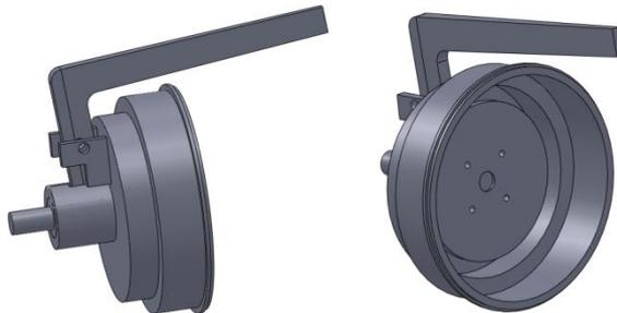
Figura 4.11 Conjunto de accionamiento de embrague
