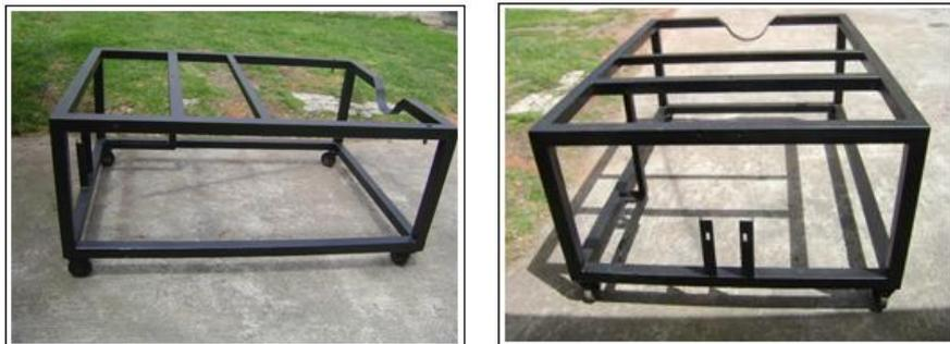
Figura 5.9: Estructura de la caja de tracción posterior terminada.
