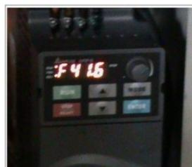
Figura 6.17: Variador de frecuencia a 2500 rpm o 41,66 Hz.
