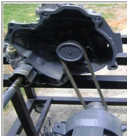
Figura 5.37: Mecanismo de transmisión de movimiento de la caja de velocidades tracción delantera.
