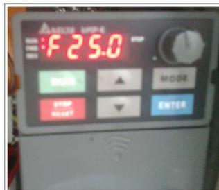
Figura 6.7: Variador de frecuencia a 1500 rpm o 25 Hz.
