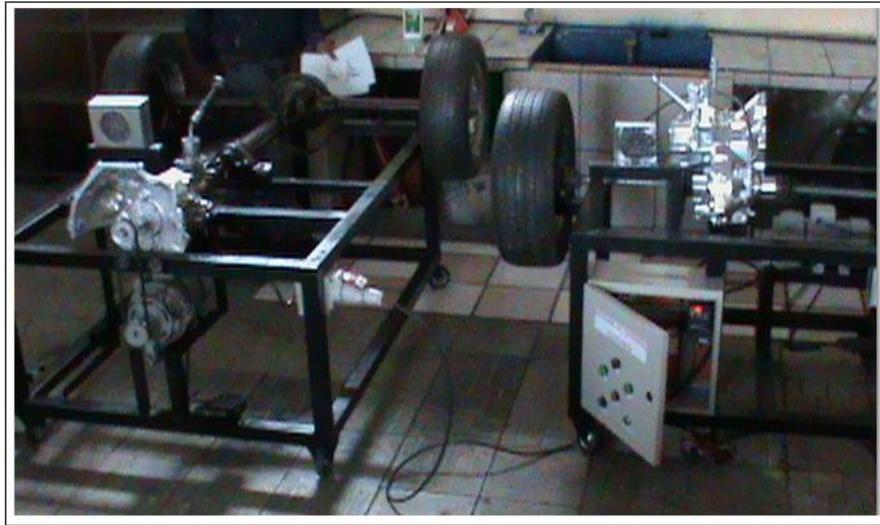
Figura 5.43: Alimentación eléctrica a los simuladores.
