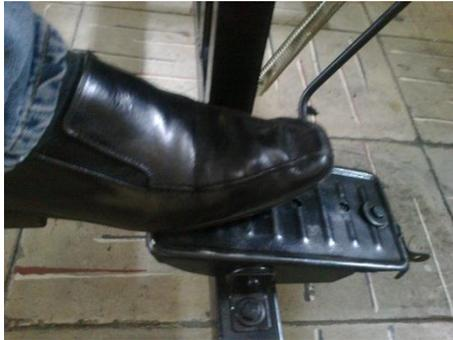
Figura A19. Accionamiento del pedal de embrague de la caja de tracción posterior.
