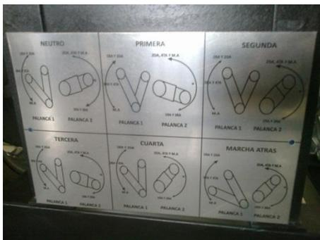
Figura A23. Instructivo para el accionamiento de las marchas en la caja de tracción delantera.
