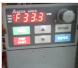
Figura 6.43: Variador de frecuencia a 2000 rpm o 33,33 Hz.
