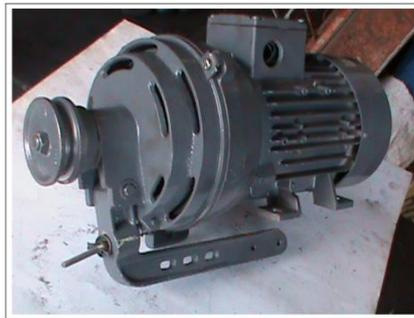
Figura 5.22: Mecanismo del embrague terminado.
