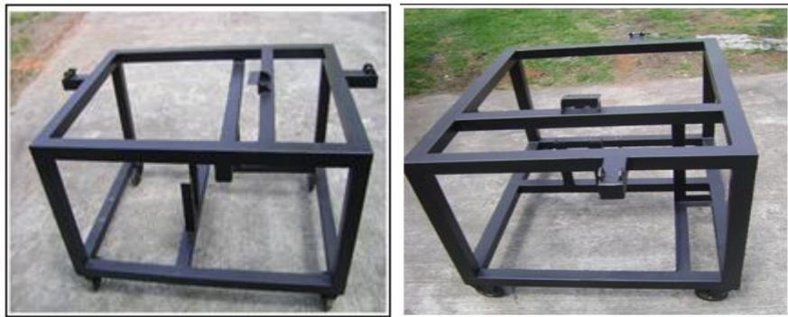
Figura 5.10: Estructura de la caja de tracción delantera terminada.
