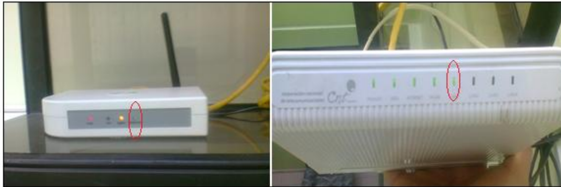
Leds indicadores de la conexión entre el Gateway ZigBee y el router HG520c.
