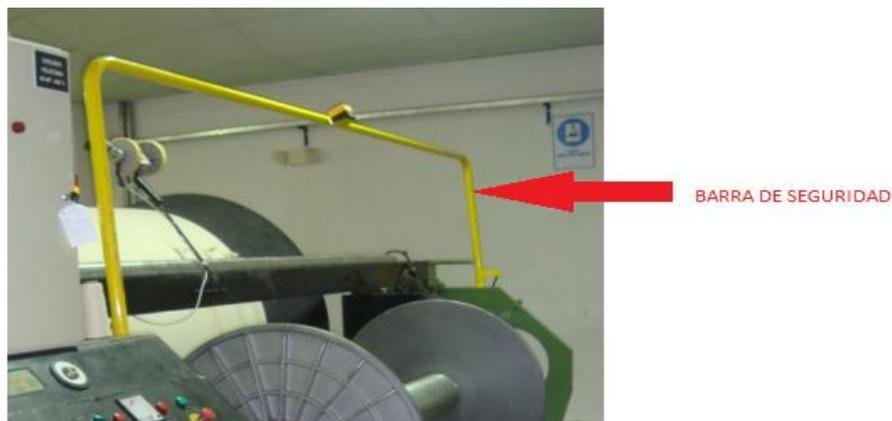
*Figura 1. 6.- Barra de seguridad levantada, en esta posición no es posible plegar.*
