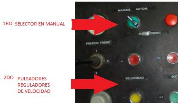
**Figura B.45** Imagen indicando como regular la velocidad.
