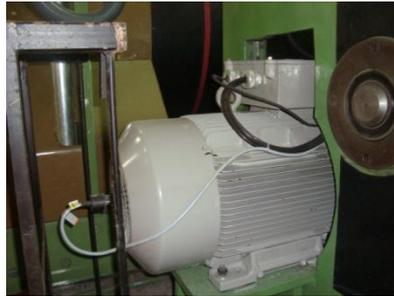
**Figura B.15** Motor utilizado para el proceso del plegado.
