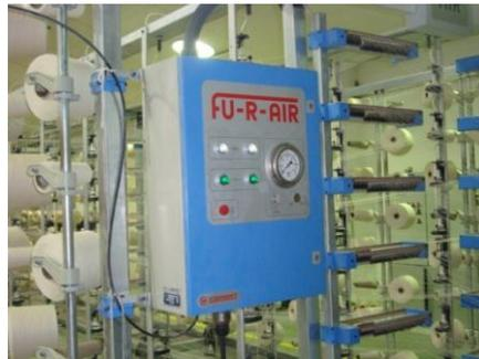
**Figura B.4**Imagen del tablero de control del paraurdimbres.
