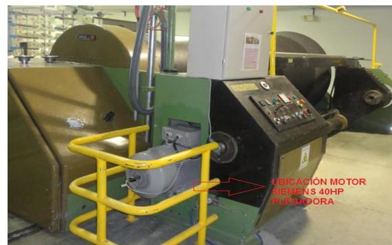
*Figura 3. 14.- Motor instalado para el funcionamiento del plegado
