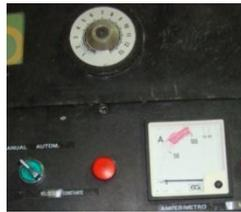
**Figura B.13** Indicador de la regulación del mecanismo que regula la velocidad de plegar.
