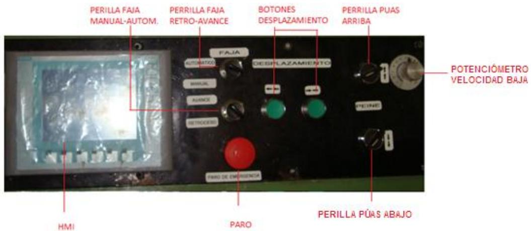
Figura 3. 3.- Aspecto físico del panel operador.
