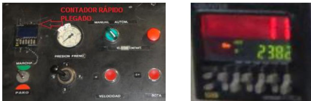
*Figura 3. 12.- Contador rápido instalado en el plegador.
