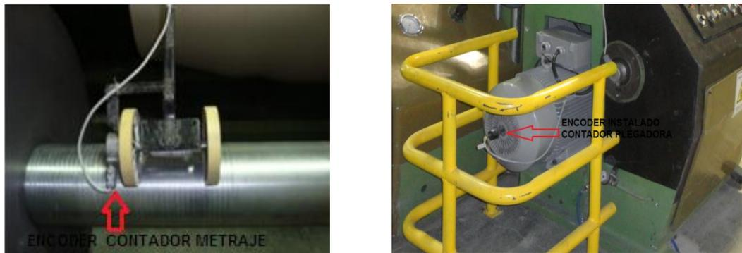
*Figura 3. 8.- Dispositivo utilizado para contar el metraje en el plegado.
