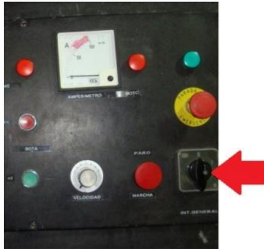
**Figura B.293** Ubicación del interruptor general energizar el plegador.
