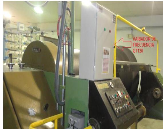
*Figura 3. 13.- Variador de frecuencia instalado
