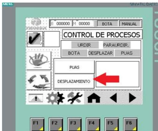
**Figura B.36** Ubicación del botón DESPLAZAR para activar el desplazamiento.
