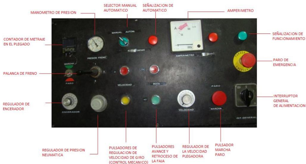
**Figura B.11** Aspecto físico del panel operador de la plegadora.
