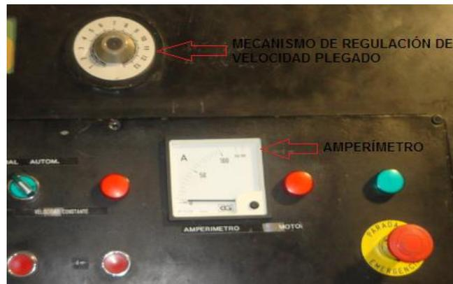
*Figura 3. 9.- Indicador de la regulación del mecanismo que regula la velocidad de plegar.*
