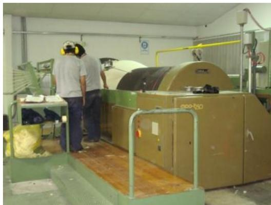
**Figura B.3** Imagen de la urdidora en el proceso de urdido.
