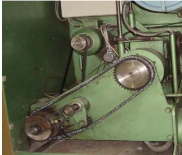
*Figura 1. 3.- Sistema mecánico del desplazamiento de la faja cuando esta engrana.*
