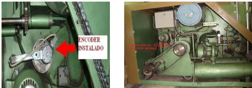
Figura 3. 10.- Apariencia del encoder instalado
