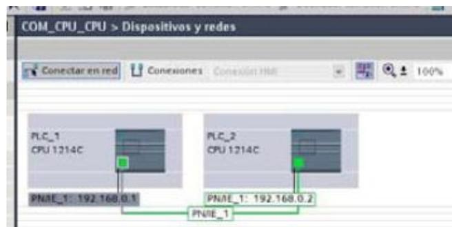
Figura 2. 26.- Configuración física que muestra el software cuando los dispositivos se encuentran interconectados.
