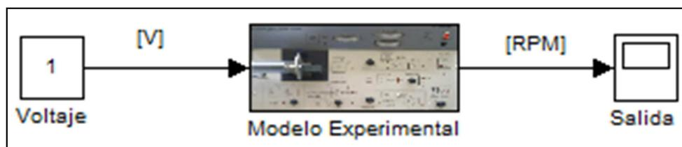
**Figura 3.10: Estructura tipo caja negra**
