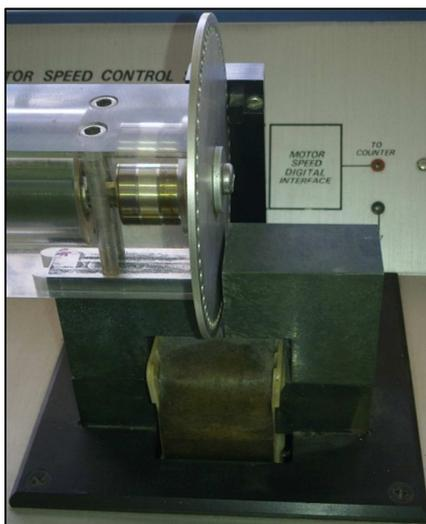
Figura2.4: Acoplamiento disco-eje del motor.
