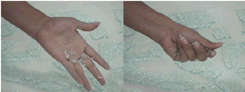
Figura 2.6. Comportamiento de un cristal templado ante un impacto
