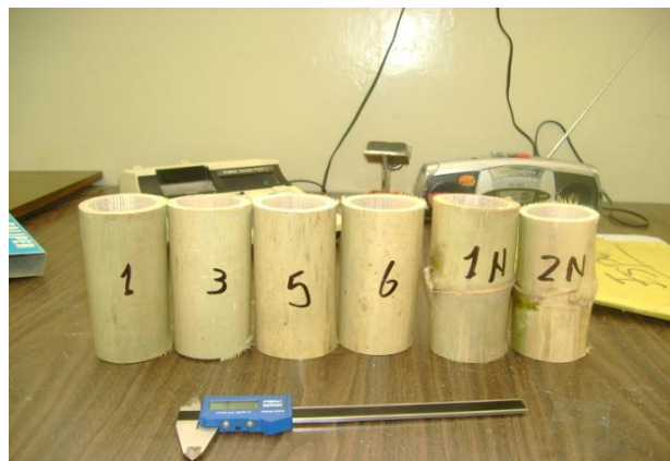
Imagen 2.14 Cilindros de Compresión para los Ensayos (Fuente Cobos, León ESPE, 2007)
