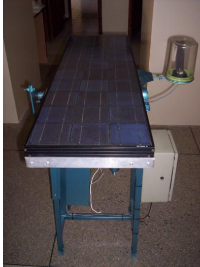
Fotografía 4.6 Panel Fotovoltaico con rotación en un eje
