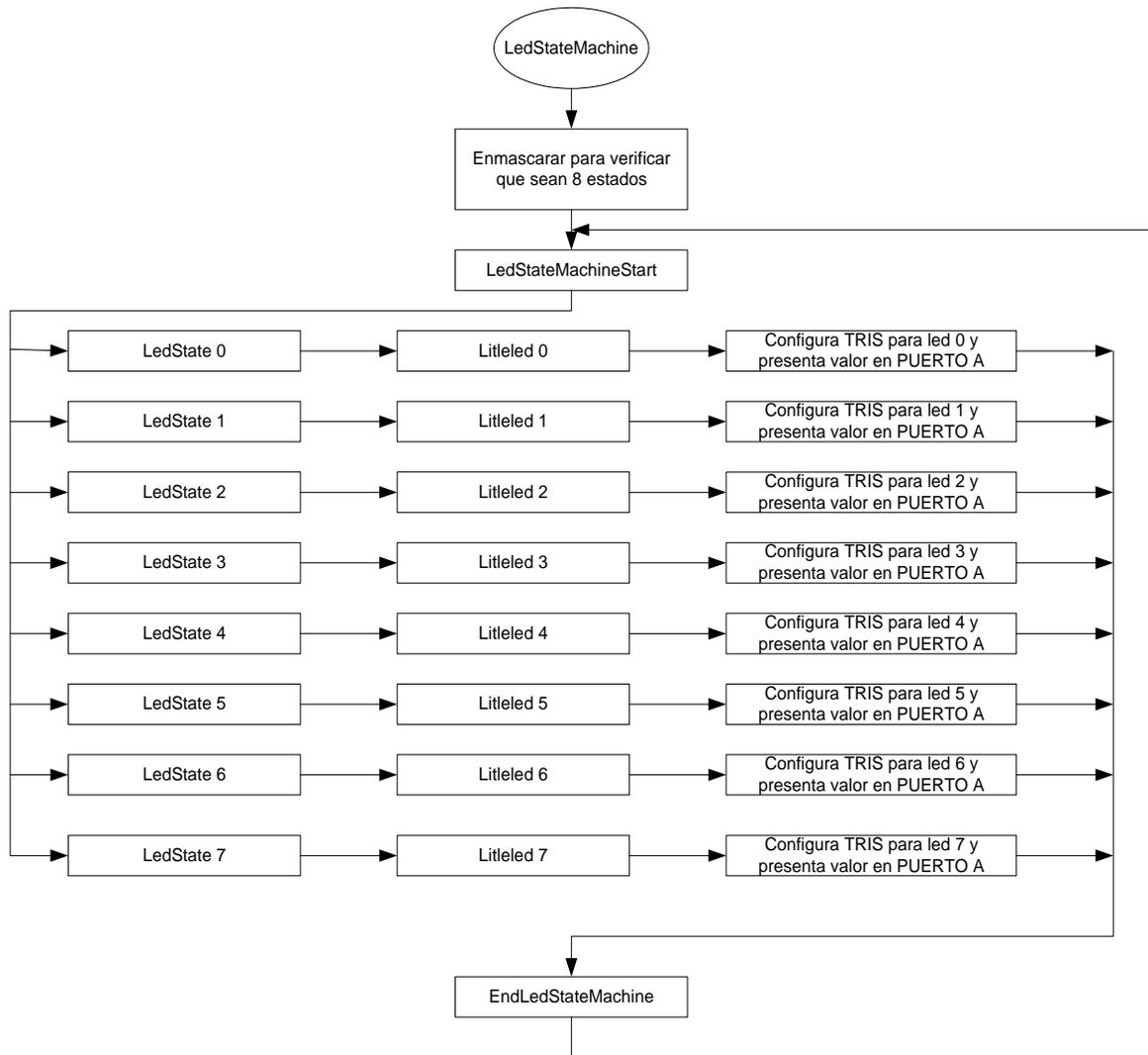
**Ilustración 102** Diagrama de flujo del programa rcvr\_demo – subrutinas 3
