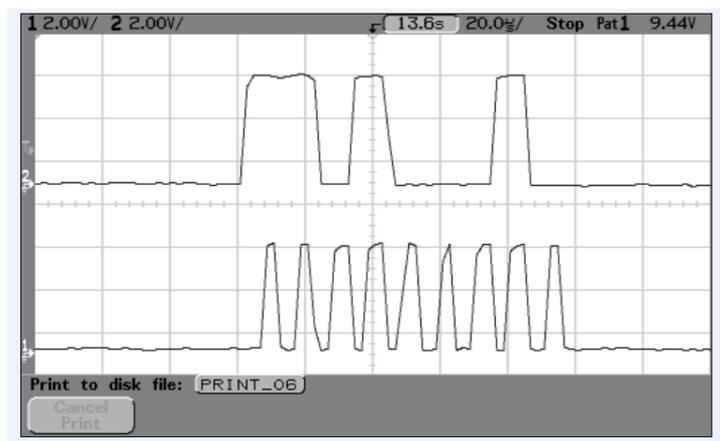
**Ilustración 66 Dirección del esclavo con operación de lectura, 0xD1H**
